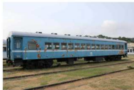
舊打狗驛故事館的露天展示環境，不利於客車車輛保存。先前 SP32426 二等對號客車鏽蝕嚴重，儘管最後由高市府籌措財源修復，卻不是長久之計。（攝影／陳冠達）
